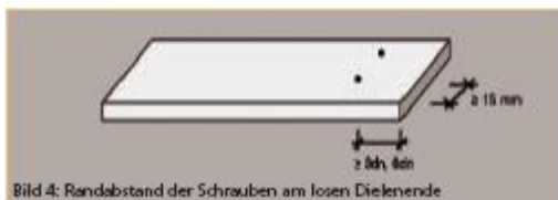
Bild 4: Randabstand der Schrauben am freien Dielenende
